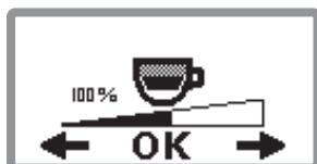
La quantité de remplissage se laisse régler entre 50% et 150%.
