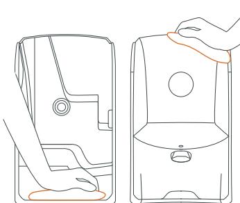
Vous pouvez nettoyer l'intérieur du châssis métallique à l'aide d'un chiffon et d'eau savonneuse.
