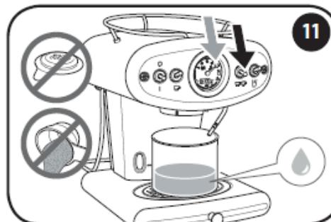
Enfoncer puis relâcher le bouton ☕☕. Dans le cadran, l'aiguille se déplace sur l'icône ☕ et la machine commence la distribution d'eau du groupe de distribution café. La distribution s'arrête automatiquement.
