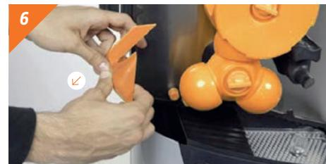
Démonter l'extracteur de peau en tirant sur le côté.
