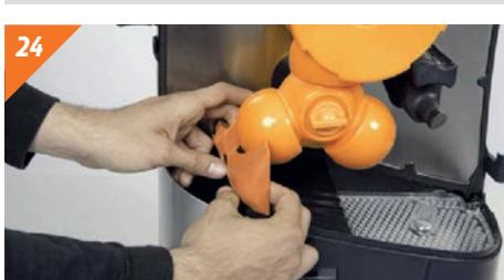
Replacer l'extracteur en l'insérant bien latéralement dans les pivots.
