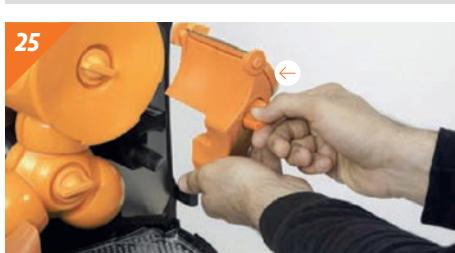
Insérer le groupe du couteau et enclencher l'axe de sécurité à l'inverse du démontage (indiqué: droite à gauche).
