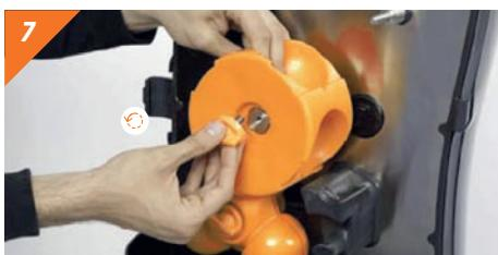
Relâcher et retirer les axes fixateur des tambours du système de pressage.
