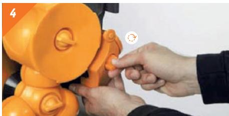
Détacher le groupe du couteau en tournant l'axe fixateur de sécurité sur 180° (gauche à droite).
