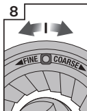
8 Réglez le broyeur supérieur réglable d'un chiffre, pour une mouture plus grossière (coarse) ou plus fine (fine)
