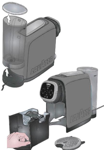
**2** Avec la machine en mode extinction automatique, et le tiroir extrait, enfoncez et maintenir enfoncés les boutons de distribution **ESPRESSO LUNGO ☕** et **DOSE LIBRE ☕** jusqu'à ce qu'un signal sonore retentisse.
