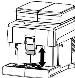
Pour effectuer ce réglage, lever ou baisser la buse de distribution manuellement.
