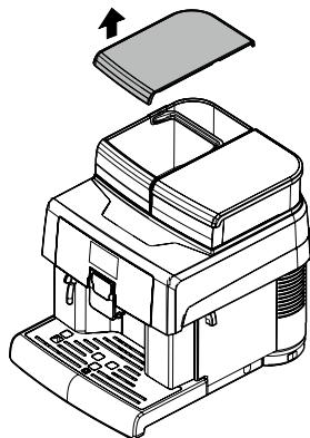
Retirer le réservoir ; le soulever par la poignée prévue à cet effet et installée à l'intérieur.
