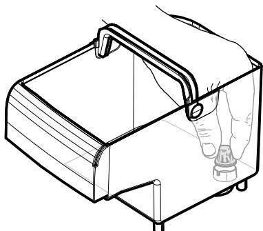
Introduire le filtre dans le réservoir vide. Appuyer jusqu'au point d'arrêt.
