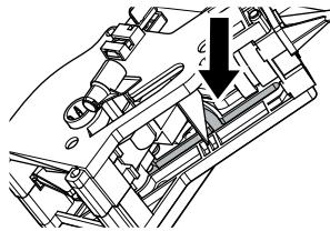
Appliquer la graisse uniformément sur les deux convoyeurs latéraux.
