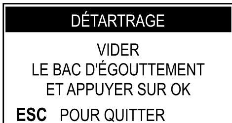
Vider complètement le bac d'égouttement et le réinsérer dans la machine.
