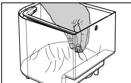
**12** Introduire le filtre dans le réservoir vide. Appuyer jusqu'au point d'arrêt.
