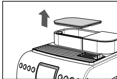
**2** Retirer le réservoir ; le soulever par la poignée prévue à cet effet installée à l'intérieur.
