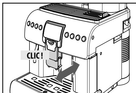
**i** S'assurer que la buse de distribution est bien positionnée ; la déplacer horizontalement jusqu'à entendre le CLIC qui indique le bon positionnement. Dans le cas contraire, des débordements de produit de l'extérieur de la buse de distribution pourraient se produire.
