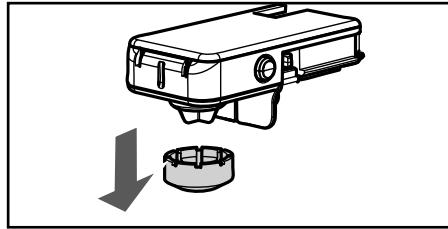
**11** Tourner le couvercle du Cappuccinatore et le soulever pour le démonter du corps du Cappuccinatore.
