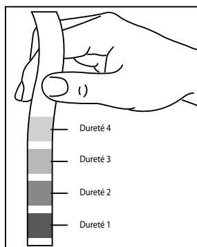
**3** Les numéros correspondent aux réglages que l'on retrouve dans le réglage de la machine illustré ci-dessous.
